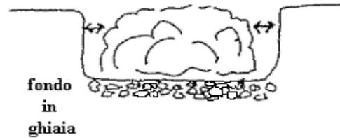
Ha il vantaggio di essere nascosta, ma, se non ben gestita, può avere gli inconvenienti di accumulare acqua (soprattutto se impermeabilizzata sul fondo) e di un insufficiente passaggio di ossigeno visto che solo la parte superiore è a contatto con l'aria.
